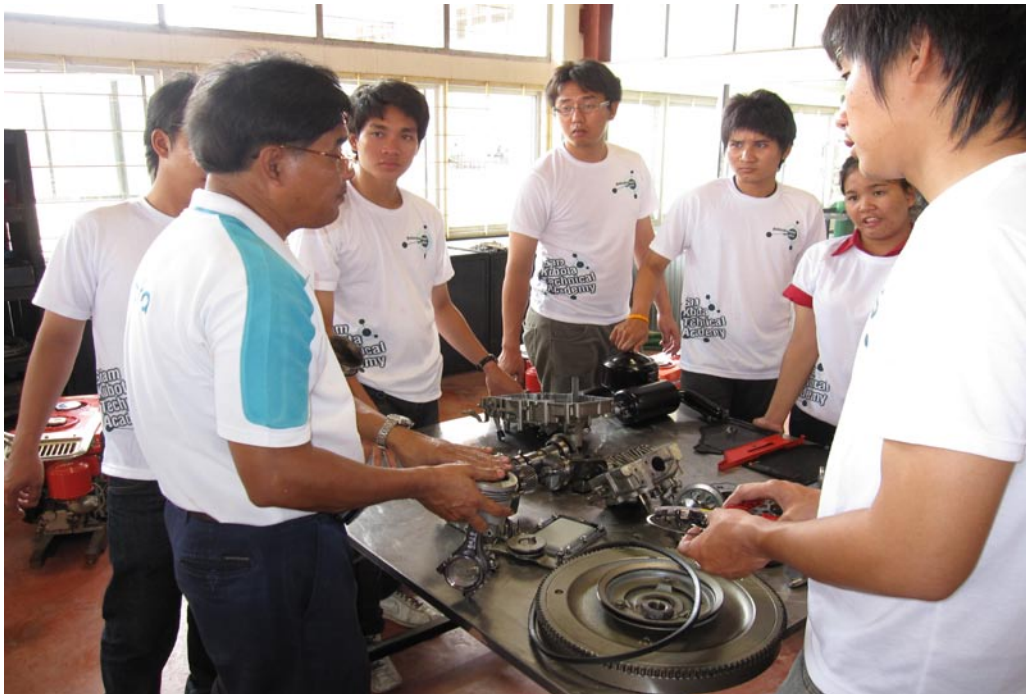
ภาพที่ 4 การประกอบลูกสูบเครื่องยนต์อเนกประสงค์ดีเซล
